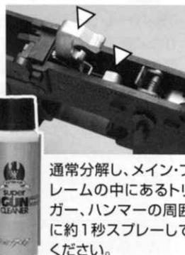
通常分解し、メイン・フレームの中にあるトリガー、ハンマーの周囲に約1秒スプレーしてください。
