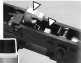
通常分解し、メイン・フレームの中にあるトリガー、ハンマーの周囲に約1秒スプレーしてください。
